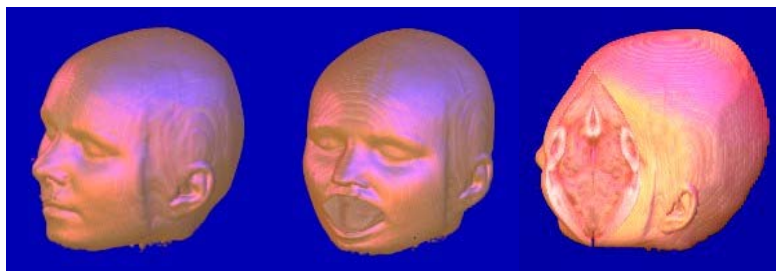
Abbildung 12: Ein Voxelmodell eines Schädels (links) wird durch diskontinuierliche Deflektoren visualisiert, so daß „Einblicke“ in den Schädel entstehen (Mitte in den Mund, rechts ins Gehirn). Dabei wurde nichts herausgeschnitten, Quelle Kurzion, Yagel [1996], S. 108 bzw. S. 109
